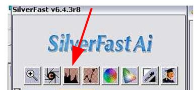
Das Histogramm ist ein sehr umfangreiches Werkzeug. Der Schieberegler am unteren Ende gibt den Wert der Farbstichtentfernung wieder, der im Optionen-Auto-Dialog eingestellt wurde. Durch einfaches hin- und herziehen können erste einfache Korrekturen ausprobiert werden. Im Handbuch ist das Werkzeug ausführlich beschrieben. Auch hier gilt, dass alle Änderungen sofort im Preview-Fenster sichtbar werden.
